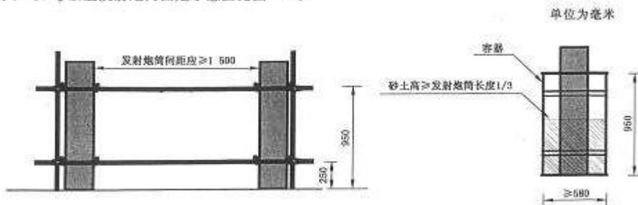
图 B.4 10号以上发射炮筒固定示意图
