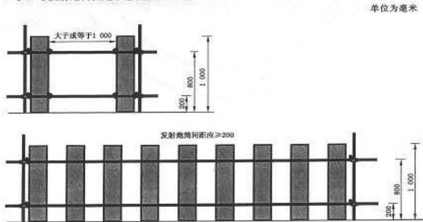
图 B.3 7号、8号发射炮筒固定示意图
