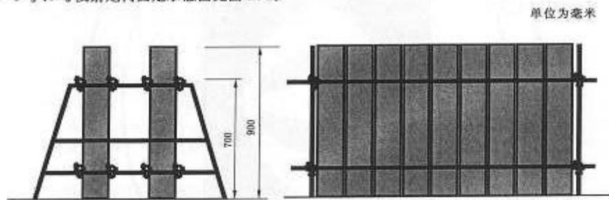
图 B.2 5号、6号发射炮筒固定示意图
