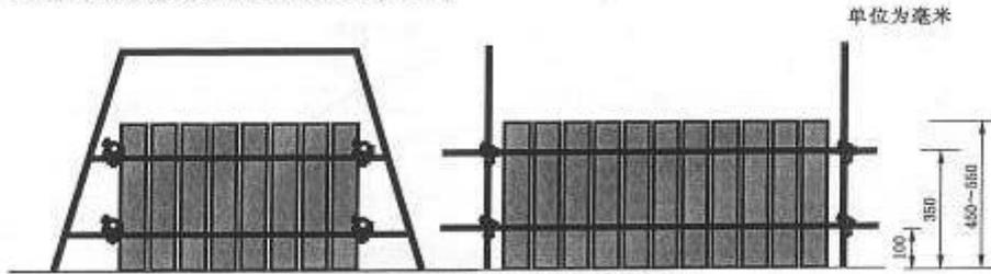
图 B.1 3号、4号发射炮筒固定示意图
